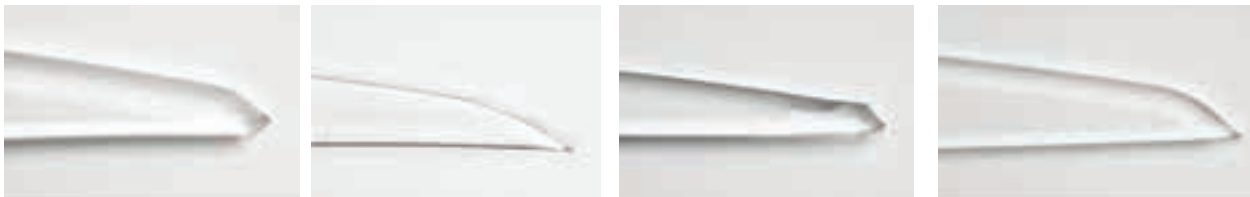
obr. 2 Řez profilem jednodenních kontaktních čoček (20× zvětšeno, -5 D). Tvar okrajů kontaktních čoček může ovlivnit manipulaci s kontaktní čočkou (JJVC Data on file, 2013).
