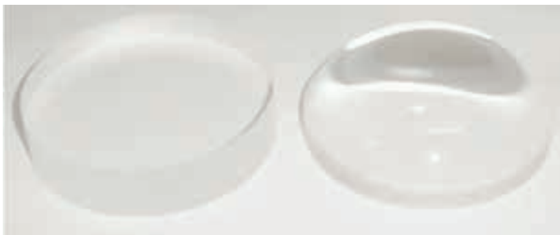
obr. 1 Polotovar sází +0,5 D ( r = 1\,000 mm) a s +12 D ( r = 41,6 mm) u indexu lomu 1,5 (Šimovič 2012).
