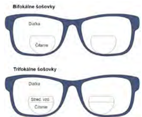
obr. 3 Rozdiel medzi bifokálnymi a trifokálnymi šošovkami [12].
