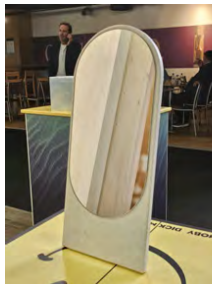
obr. 6 Zkušební zrcadlo vyrobené z recyklovaných plastů s patrnými kousky hliníku pocházejícího z obalů od Capri Sun.
