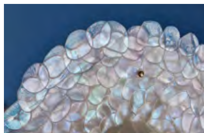
obr. 3 Materiál DELEREX® od Yaira Neumana vzniká recyklací brýlových čoček (zdroj: Yairneuman.com).
